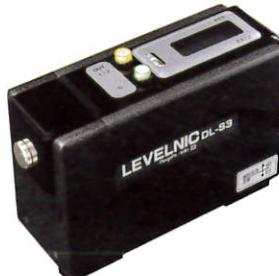
▲同社の特許商品の中で代表的なものが、デジタル式の水準器「レベルニック」。最小読み取り値0.001mm/mの高い精度で工作機械の水平出しや、平面度・直線度測定に威力を發揮。他の測定器と比べ、簡単に短時間で測定でき、コストパフォーマンスに優れている。
