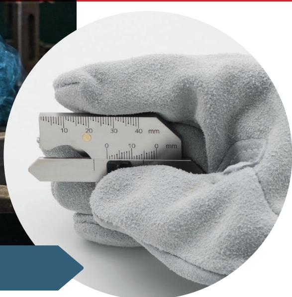
使用例 溶接加工の必需品! 溶接の余盛・すみ肉・脚長等の寸法測定がこれひとつでできる!
