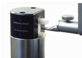
① 付属のマスターで 測定子径を校正
