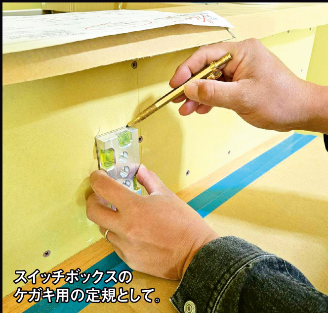
センター穴付なので、 スイッチボックスの窓あけ用のケガキができる。
