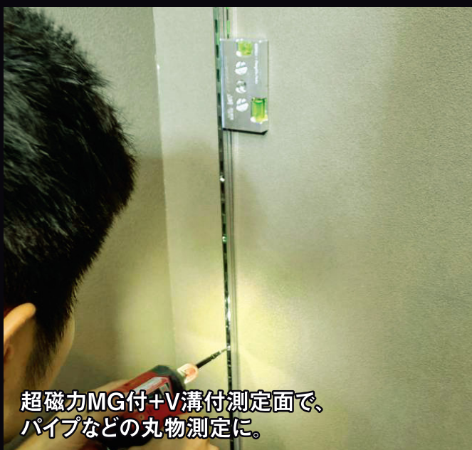
スイッチボックスの ケガキ用の定規として。
