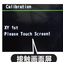
④响起哔哔的声音后画面进入「Calibration」设定界面。返回后，将本机沿水平方向旋转180°，在相同位置放置好后。
