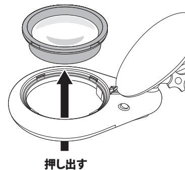
②2倍システムレンズを拡大鏡の枠に装着してください。①
