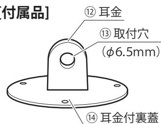
※耳金付裏蓋を使用する場合は、標準裏蓋のねじを全て外し、耳金付裏蓋と交換してねじで取り付けてください。
