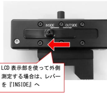
LCD 表示部を使って外側測定する場合は、レバーを『INSIDE』へ
