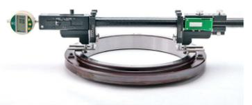
※測定子がワーク・被測定物に斜めに接しないよう注意してください。
