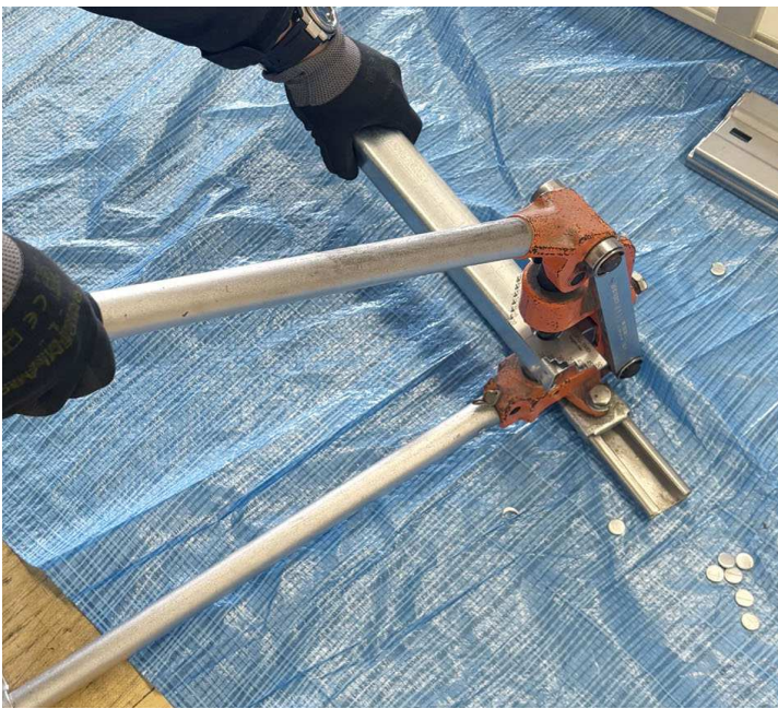
◇ネグロス電気社製「チャンネル穴あけ工具 MAKD」に取り付けて使用
